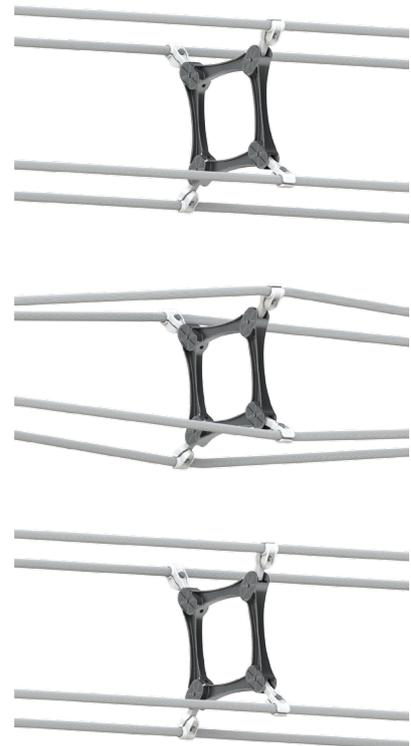
Diese Druck- und Zugkräfte werden von den RIBE® selbstdämpfenden Feldabstandhaltern im Kurzschlussfall aufgenommen, ohne dass bleibende Verformungen auftreten und eine Beschädigung der Seile eintritt.
